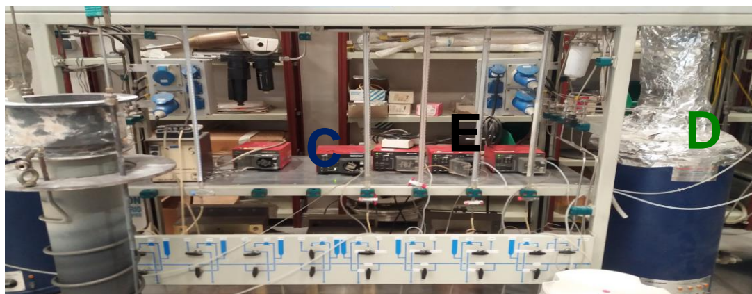
Figura 13- Bombas (C), buretas (E) e banho responsável pela vaporização da água (D).
