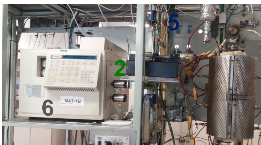
Figura 17- Coluna de água (5), seringa e bomba de injeção (3) e cromatógrafo (6).
